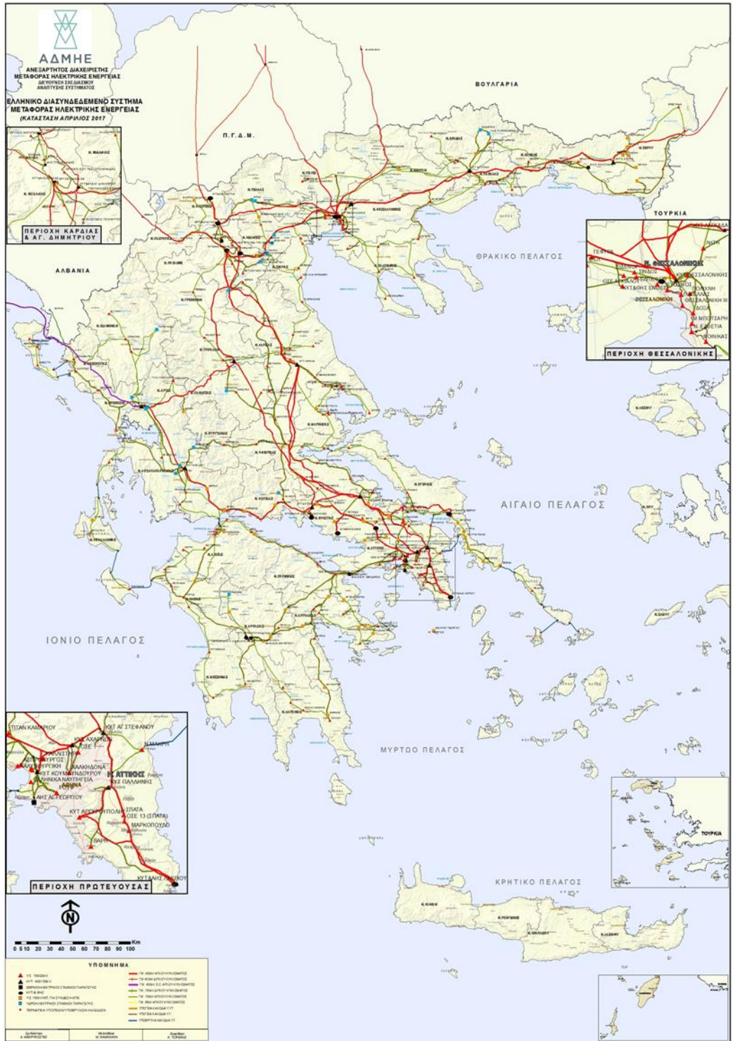
Εικόνα Α.1: Εθνικό διασυνδεδεμένο σύστημα ηλεκτρικής ενέργειας 19 .
